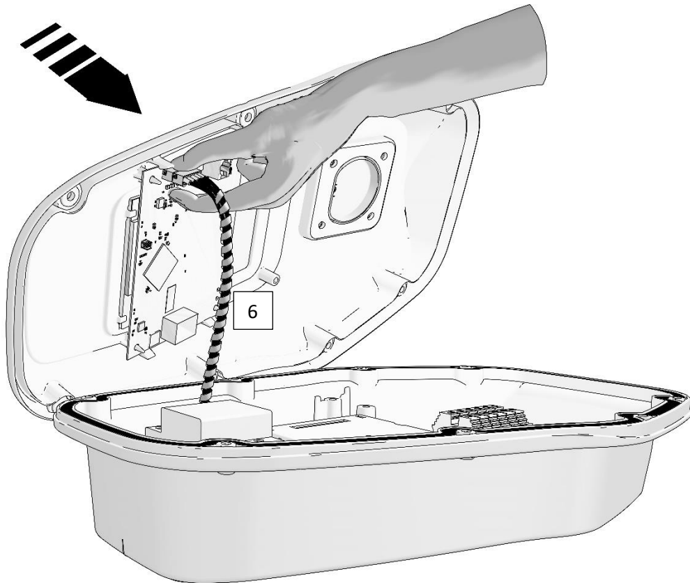
Bild 6 Entfernen des Verbindungskabels
