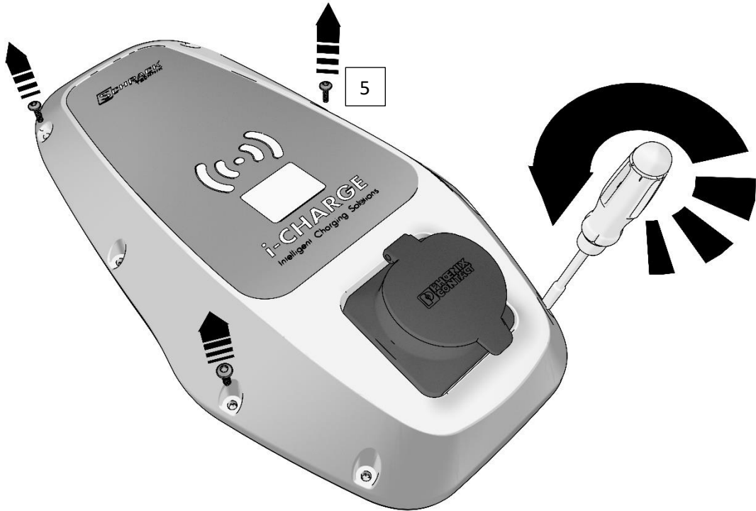
Bild 5 Öffnen des Deckels
